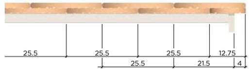
Vous relèverez les spécifications concernant l'espacement des lattes, la largeur de couverture et la pente de toit ainsi que les dispositions de garantie sur l'annexe «Couverture de tuiles en terre cuite - principes d'utilisation».
