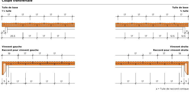
Vous relèverez les spécifications concernant l'espacement des lattes, la largeur de couverture et la pente de toit ainsi que les dispositions de garantie sur l'annexe «Couverture de tuiles en terre cuite - principes d'utilisation».
