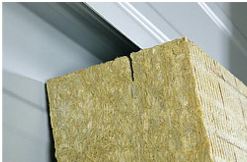
Panneau isolant bicouche avec couche intérieure élastique et couche extérieure plus dure avec rainure longitudinale. Insertion dans des cassettes métalliques avec revêtement ventilé.
