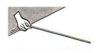
Dans le cas où le béton serait très dense, enfoncer la barre à rainer, avec des mouvements de va-et-vient, dans le béton fraîchement coulé. Retirer la barre à rainer. Cette opération divise l'agrégat suivant une ligne et permet au MAXI-JOINT d'être plus facilement inséré.
