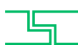
AK-80 Battue 4 côtés, dès 35 mm d'épaisseur Format utile 1988 x 588 mm Pour tous les produits
