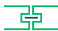
AK-95 Rainure et languette en bois 4 côtés, dès 35 mm d'épaisseur Sans perte de format utile Pour tous les produits
