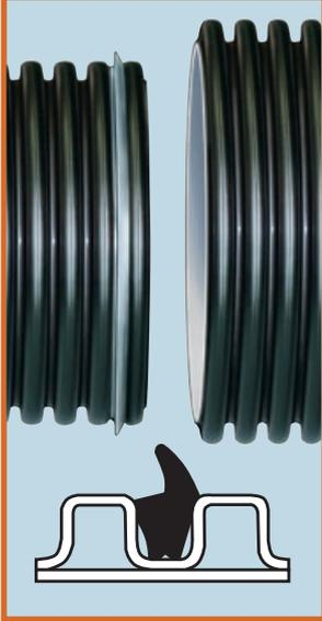
TWIN ECO SN16 est le nouveau tube annelé en PP (polypropylène à haut module), double paroi, dimensionné sur le diamètre intérieur, pour conduites d'évacuation enterrées sans pression conforme à la norme UNI EN 13476-3. Le caractère innovant consiste en son système de jonction conçu directement sur la barre tout en maintenant le profil du tube conservant ainsi les mêmes caractéristiques mécaniques de résistance.
