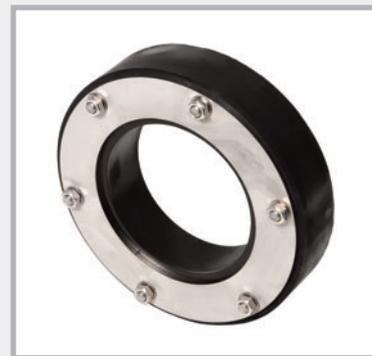
**Montage :** après avoir posé l'insert d'étanchéité et effectué le passage du tube du milieu, serrer les vis en croix. Serrer chaque vis plusieurs fois d'un tour, afin que la bague d'étanchéité se comprime régulièrement. Couple maximal M6 = 5 Nm, M8 = 10 Nm, M10 = 15 Nm, M12 = 20 Nm. Resserrer encore une fois au bout de 2 – 3 heures.
