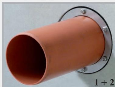
3. Serrer les vis en croix d'un tour. Répéter cette procédure jusqu'à ce que toutes les vis soient serrées avec un couple de 5 Nm. Resserrer encore une fois les vis au bout de 24 heures.
